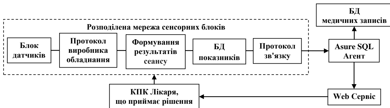
Рис. 1 – Структура інформаційно-аналітичної системи телемоніторингу
