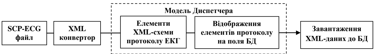
Рис. 4 – Модель програмного модуля «Диспетчер»
