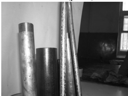
Рис. 1. Поверхні металу зразків труб і ТЕНу після очистки накипу та іржі протионакипним розчином.
