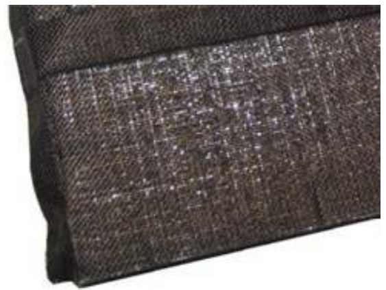
Рис. 3. Вакуумна ізоляція: а – в оболонці із склотканини; б – покриті шаром штучного каучуку
