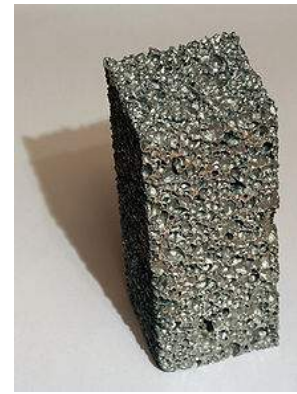
Рис. 2. Пінометал на основі алюмінієвого сплаву
