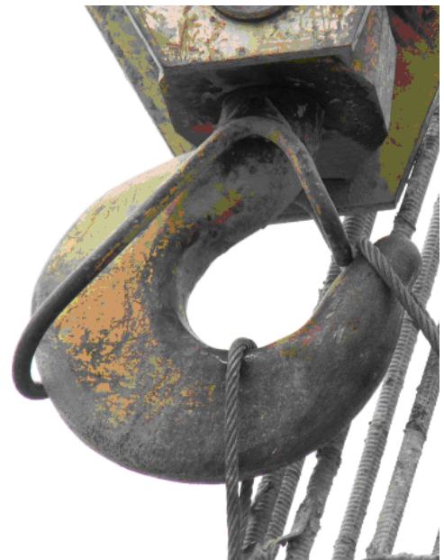
Рис. 1. Вихід стропа із гака крана КС- 6476
