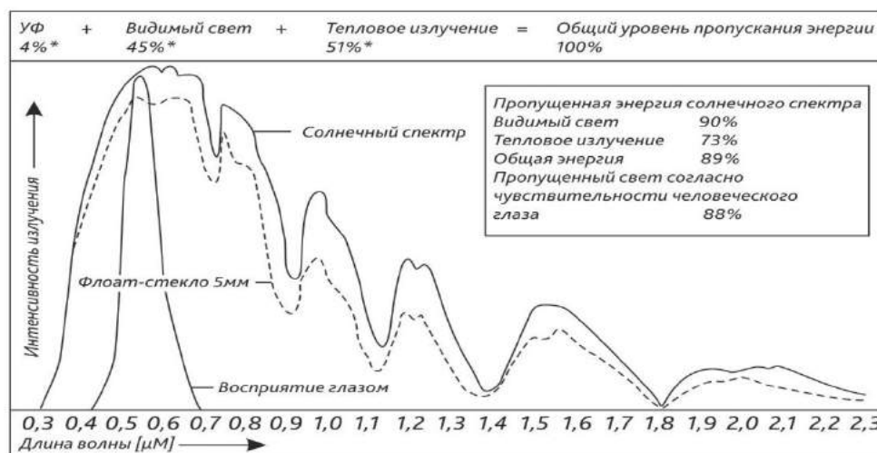
Рис. 1. Світлопропускання флоат-скла 5 мм залежно від інтенсивності сонячного спектра
