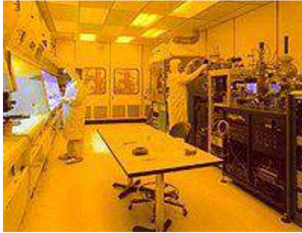
Рис. 2. Невелике чисте приміщення для виробництва мікроелектроніки
