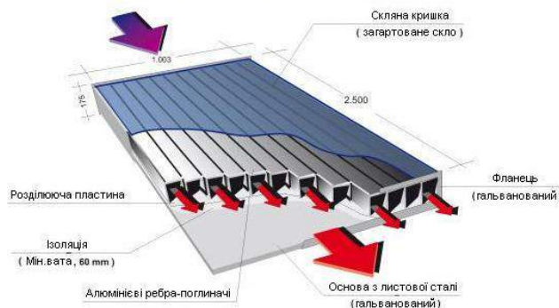
Рис.2. Загальний вигляд сучасного повітряного сонячного колектора на прикладі колектора Grammer JumboSolar
