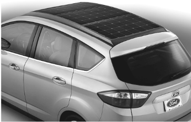
Рисунок 1. Концепт електромобіля, в конструкцію якого інтегровані геліоколектори
