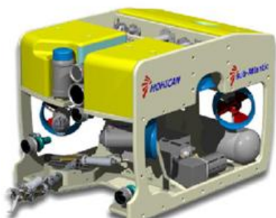
Рис. 4. Підводний апарат, рушійний комплекс якого організовано за чотирьохвальною схемою з розміщенням рушіїв під кутом до діаметральної площини апарата
