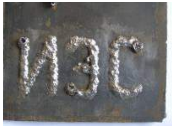
Рис. 6. Дуговая наплавка автоматом под водой с программированием двухкоординатного перемещения сварочного инструмента
