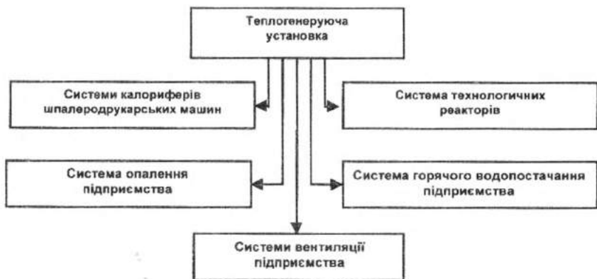
Рис. 1. Застосування водяної пари, як проміжного теплоносія
